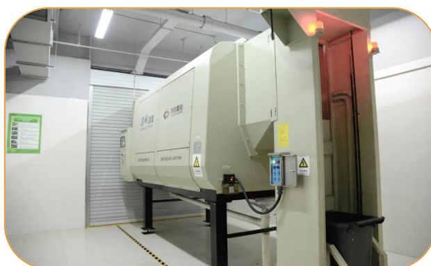
图：北京经济技术开发区亦城财富中心旋转式垃圾压缩贮存机示例
